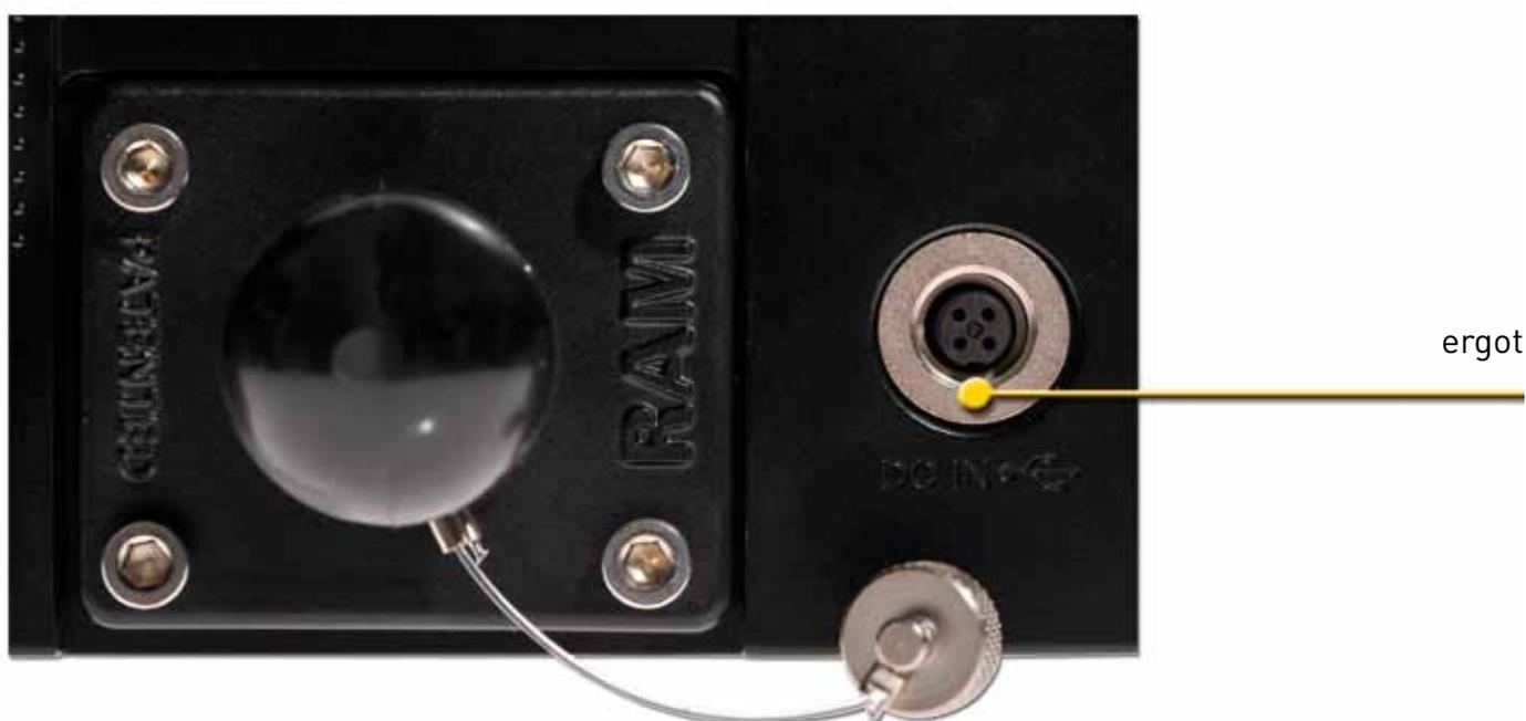
Le connecteur de Tripy II est utilisé pour recharger les batteries de l'appareil, pour connecter l'appareil à un PC via une liaison USB ou encore pour connecter Tripy II au câble d'alimentation véhicule référence 9020.
