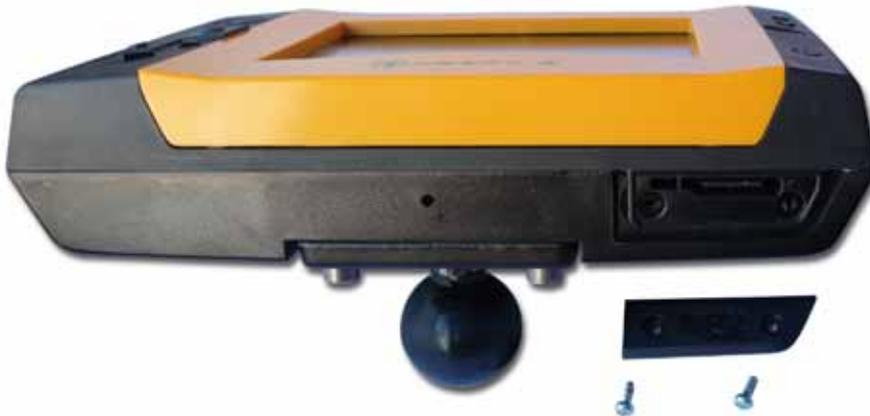
La petite trappe située sur la face latérale inférieure de Tripy II abrite une mémoire Micro SD de 4G octets qui est en fait le disque dur de votre Tripy. Cette trappe abrite également un micro interrupteur de remise à zéro de l'appareil.
